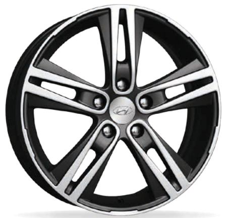
R8400M0004 Диск колесный, легкосплавный, размер 6,5J x 17, черный «Бриллиант»
